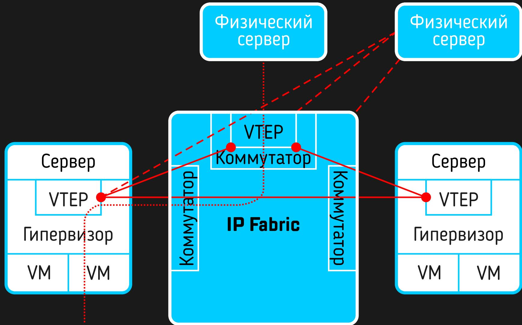
Помимо подключения виртуальных рабочих нагрузок (как показано на рисунке), шлюзы VTEP также могут обрабатывать мост VLAN на VXLAN для подключения физических и виртуальных рабочих нагрузок.
