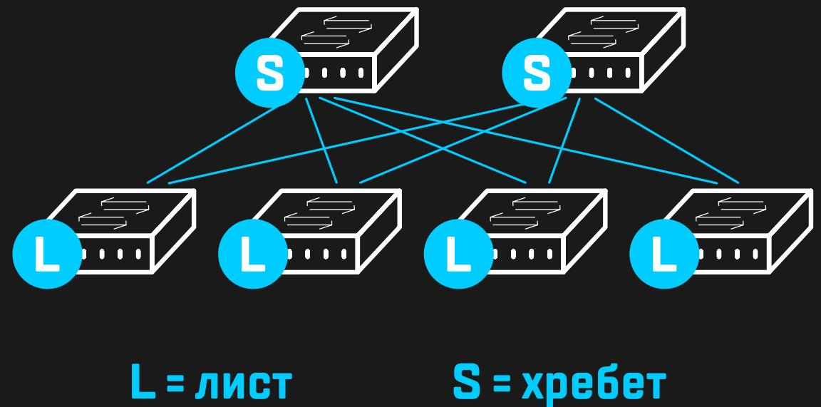
Многие современные сети уже разработаны таким образом и часто называются сетями Spine/Leaf (хребта и листьев). Листовые устройства обеспечивают подключение к доступу, в то время как устройства позвоночника действуют как точки агрегации. Обычные многоступенчатые модели ткани IP включают в себя 3-ступенчатые Clos (три уровня: этапы 1 и 3 (лист), ступень 2 (позвоночник))
